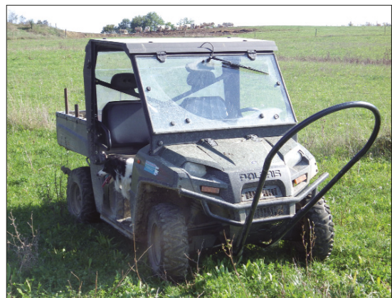
Véhicule équipé pour le franchissement des clôtures électriques
