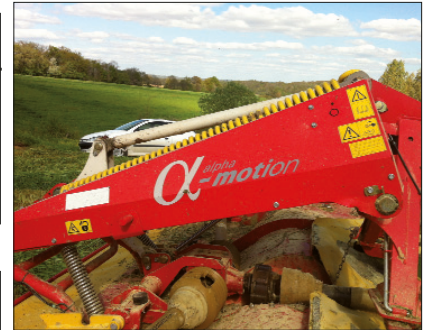
Afin de pouvoir faucher à grande vitesse, les constructeurs ont développé des systèmes de suspension très réactif aux vallons et aux creux que l'on peut rencontrer sur les parcelles. Ici, le système de Pottinger.
