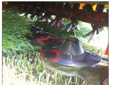
Les conditionneurs à fléaux sont les modèles les plus vendus car plus polyvalents. Chez certains constructeurs de nombreuses options sont disponibles avec ce type de conditionneur.
