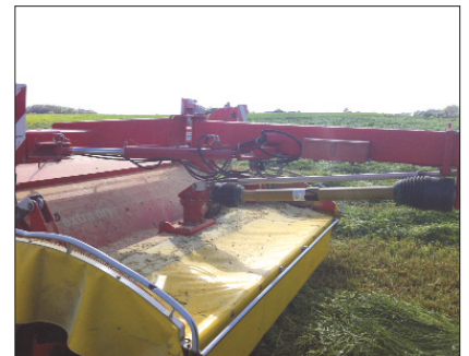
Pour les faucheuses traînées, la vitesse de rotation de la prise de force doit être impérativement de 1000 trs/mn pour préserver la cinématique d'entraînement de l'outil.
