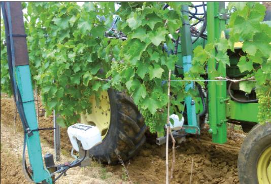
Des économies d'herbicides de l'ordre de 60 % sont possibles grâce à ce dispositif (jusqu'à 80 %). La démonstration sur une des parcelles du domaine a permis de montrer l'efficience de la technologie malgré une vitesse de passage relativement faible.
