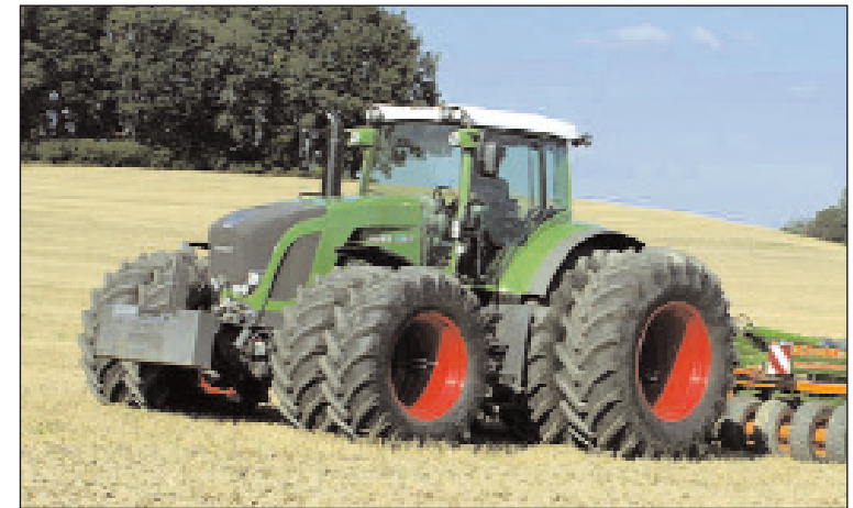
Les passages de roues constituent des voies préférentielles de ruissellement de l'eau. Certains équipements, tels que les roues jumelées, modèrent ce phénomène. (Crédit photo : Fendt)
