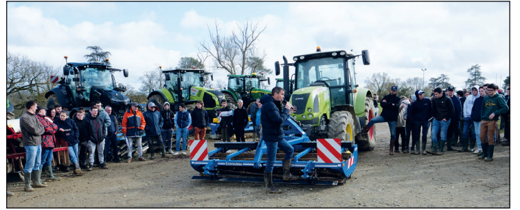
En fin d'après-midi, la présentation organisée par la FDCUMA de différentes combinaisons d'outils (rouleaux hacheurs, déchaumeur à disque, déchaumeur auto-animé, scalpeur, bêche roulante) et du travail effectué (la veille pour cause des conditions de praticabilité le jour même) a permis d'apporter certains éléments de réflexion sur la phase cruciale qu'est la destruction des couverts.
