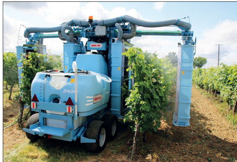
Pulvérisateur vigne avec panneaux récupérateurs face par face permettant une réduction de 90 % de la dérive.
